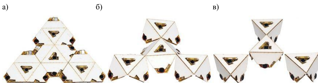
Рисунок 3 – Группа из четырех роботов оригами
